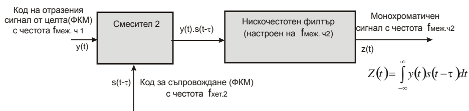
Фиг.3. Схема на корелатор (варианти на реализация)
